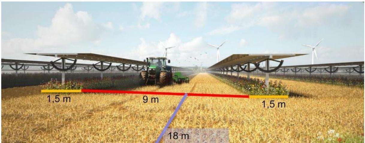
Abbildung 14: Schematische Darstellung Agri-PV Anlage (Quelle: (SolarRAinTracker, 2023)/ EWS; Wischmann)
